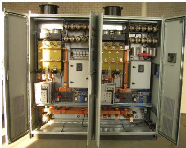
Рис. 1. Статическая система возбуждения со 100% резервом СТС-2П-160-1050 УХЛ4 на ток 1050 А и напряжение 160 В.
