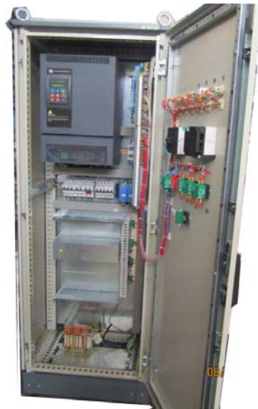
Рис.1 Внешний вид автоматического регулятора возбуждения, шкафное исполнение, 1 канал без резерва
